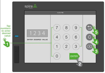
FIGURE 2.1.9 | NUMERIC INPUT SCREEN
